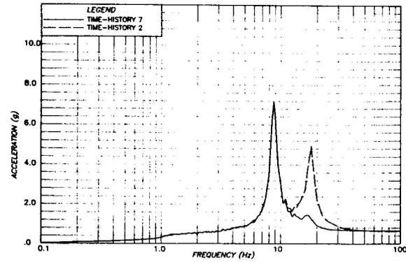
FIG. 7 - CONTROL PANEL MODEL : VARIABILITY OF T-H SPECTRA
