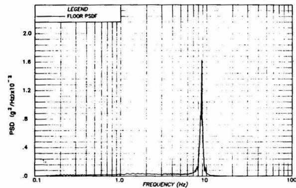
FIG. 6 - CONTROL PANEL MODEL : INPUT PSDF
